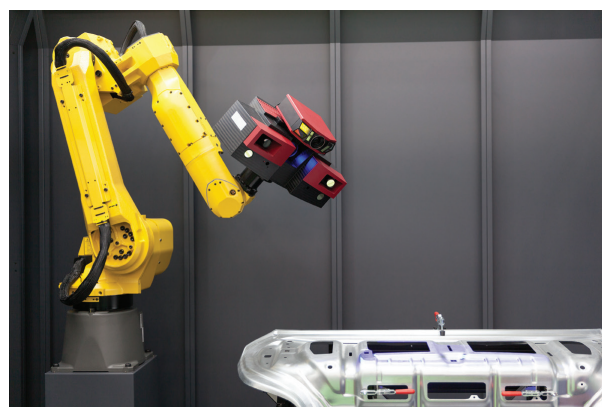
图 5. 带有 3D 扫描仪的机器人手臂
