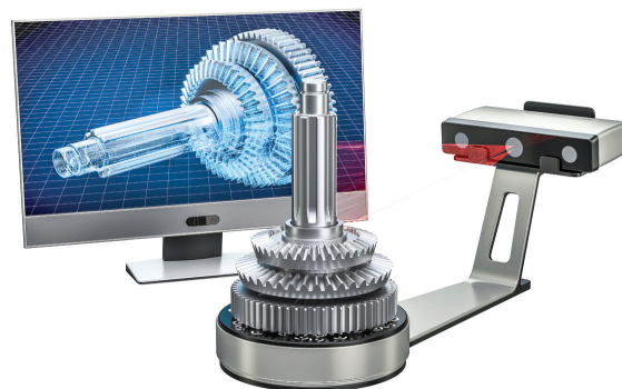
图 2. 利用结构光进行光学 3D 扫描
