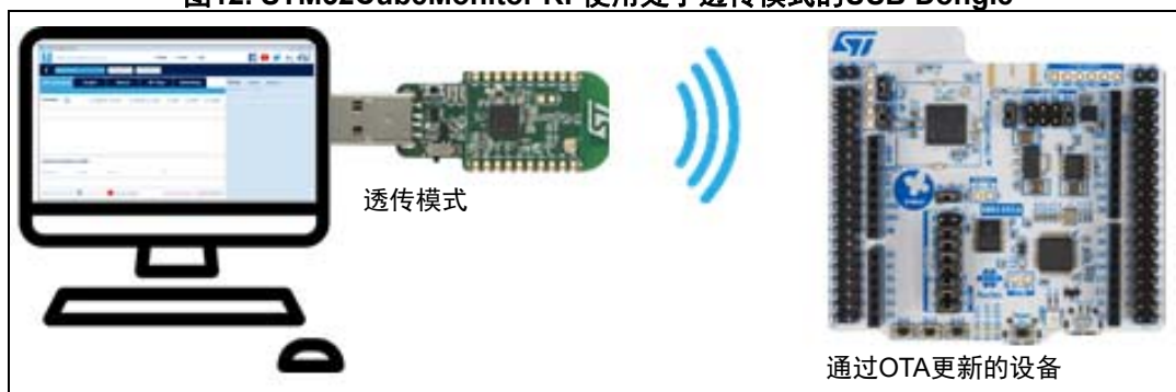
图12. STM32CubeMonitor RF使用处于透传模式的USB Dongle
