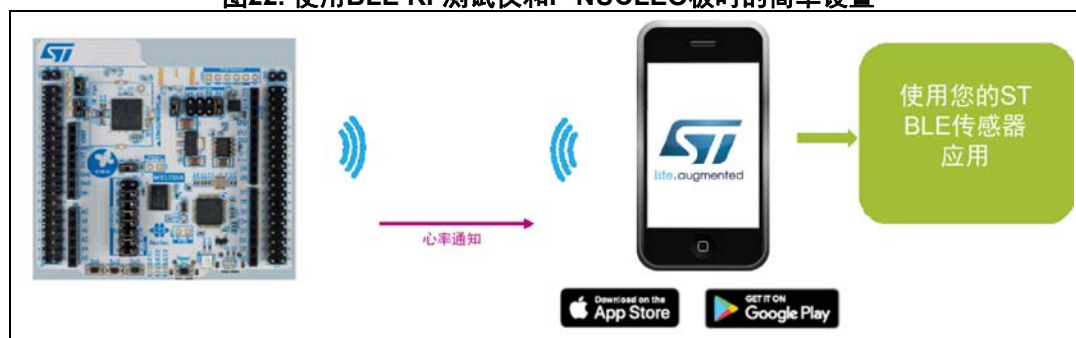
图22. 使用BLE RF测试仪和P-NUCLEO板时的简单设置
