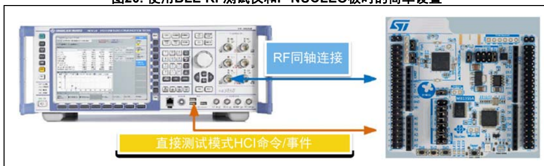
图20. 使用BLE RF测试仪和P-NUCLEO板时的简单设置
